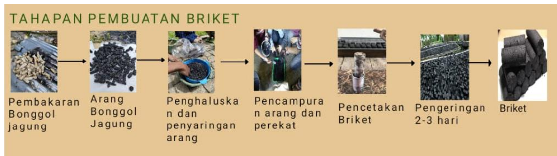
Gambar 3. Proses pembuatan Briket
