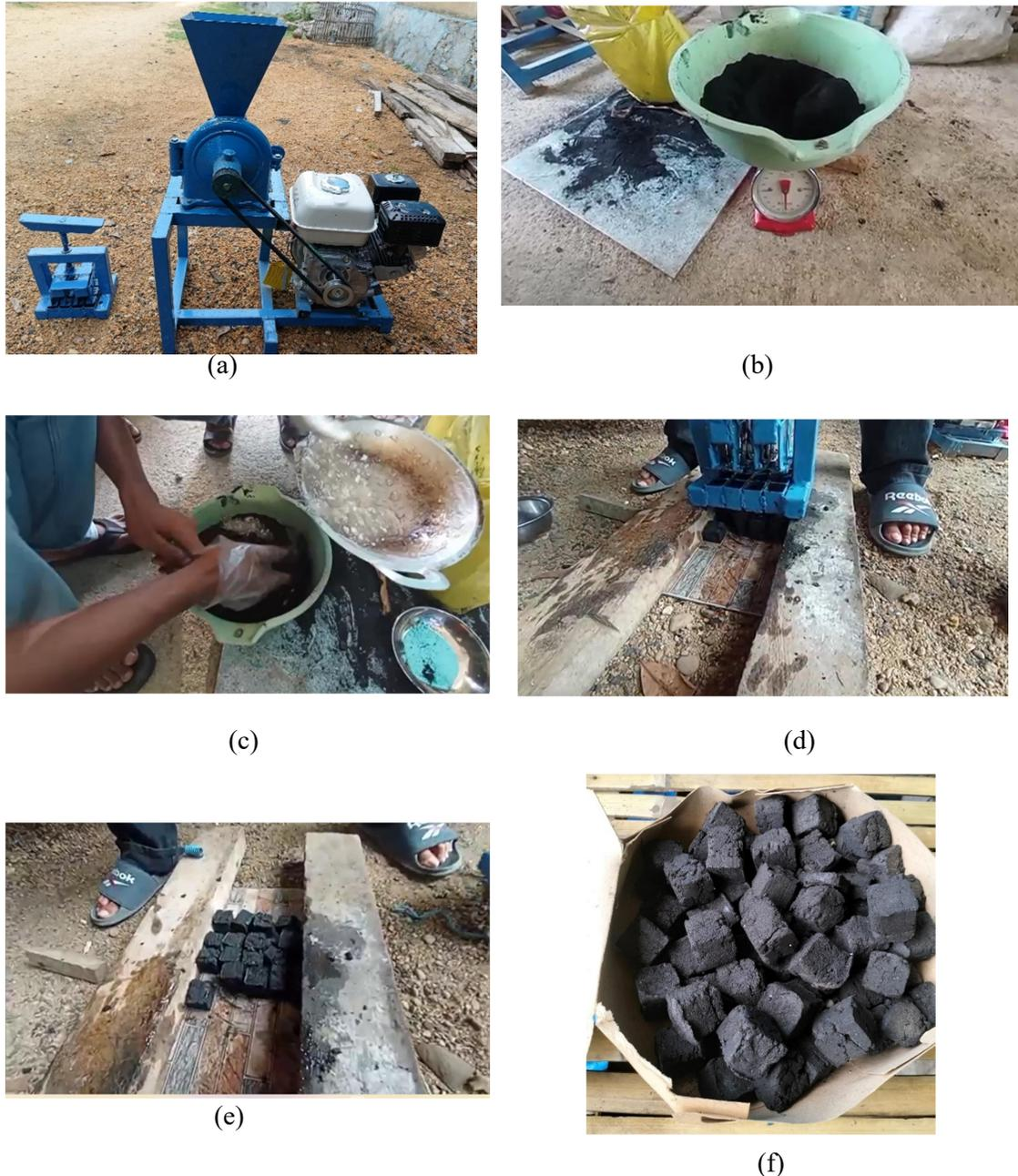
Gambar 3. (a) Alat pencetak arang briket, (b) Batok kelapa yang telah dihaluskan, (c) Proses pencampuran tepung kanji, (d) Proses pencetakan arang briket, (e) Hasil pencetakan arang briket, (f) Arang briket yang sudah dikeringkan dan siap digunakan
