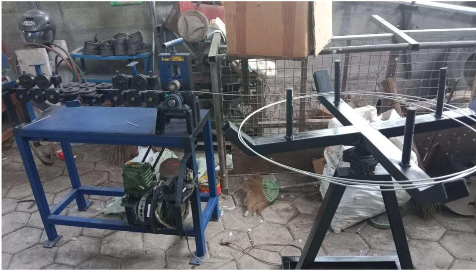
Gambar 3. Mesin Pelurus kawat yang diserahkan ke pengrajin
