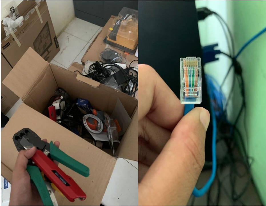
Gambar 4. Pengerimpingan kabel UTP.
